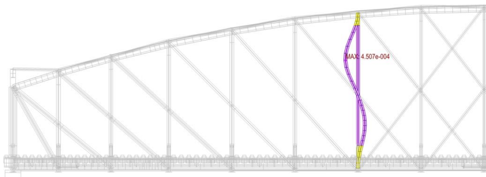
Svislice V6 - 1. kritický tvar - vybočení v rovině \alpha_{cr} = 6.35
