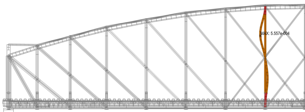
Svislice V7 - 1. kritický tvar - vybočení v rovině \alpha_{cr} = 4.54
