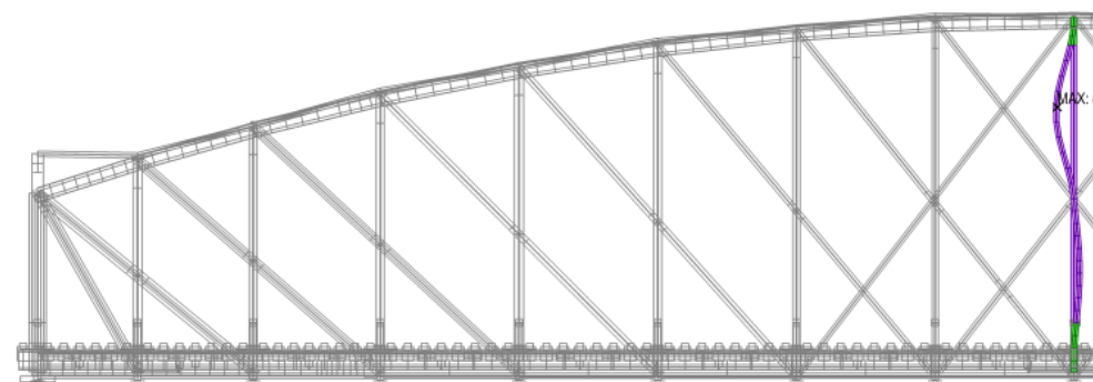
Svislice V8 - 1. kritický tvar - vybočení v rovině \alpha_{cr} = 2.85
