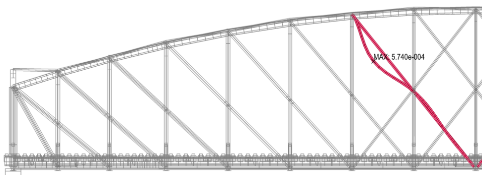
Diagonála D8 - 1. kritický tvar - vybočení v rovině \alpha_{cr} = 6.33
