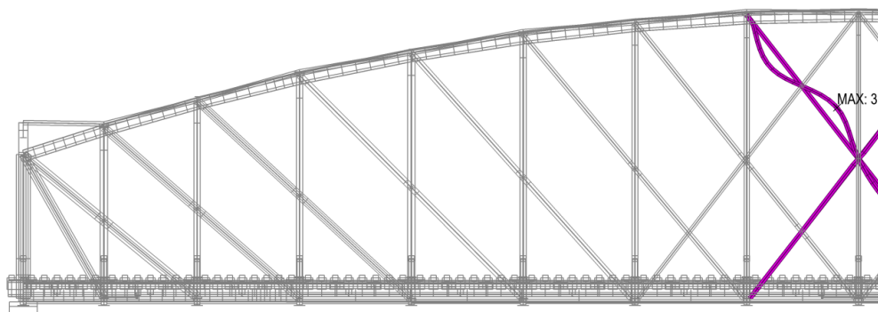
Diagonála D9 - 1. kritický tvar - vybočení v rovině \alpha_{cr} = 5.89
