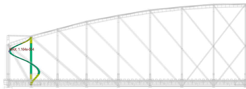
Svislice V1 - 1. kritický tvar - vybočení v rovině \alpha_{cr} = 61.54
