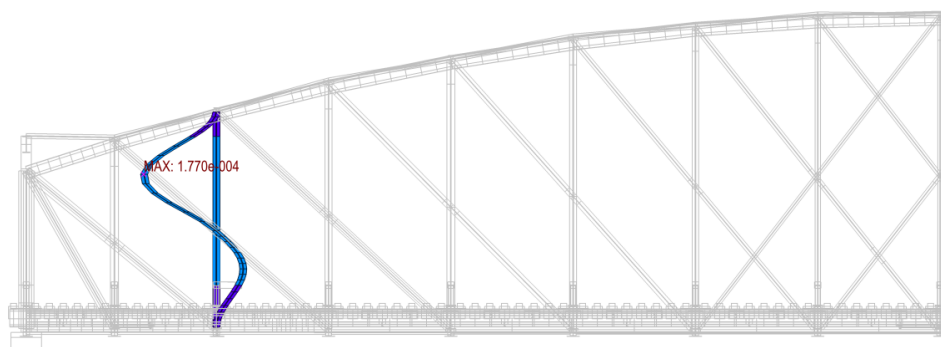
Svislice V2 - 1. kritický tvar - vybočení v rovině \alpha_{cr} = 29.66
