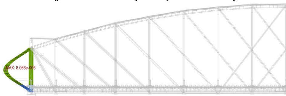
Diagonála D10 - 1. kritický tvar - vybočení v rovině \alpha_{cr} = 3.87
